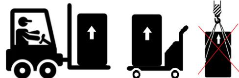
**Cihaz, dik olarak taşınmalı ve kurulduğu yerde dik ve terazisinde çalıştırılmalıdır.**
